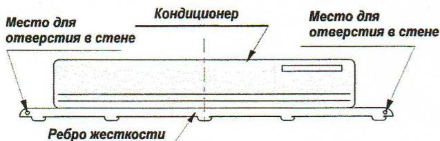
3. Просверлите отверстия, установите пластиковые дюбели и вкрутите шурупы-крючки.
