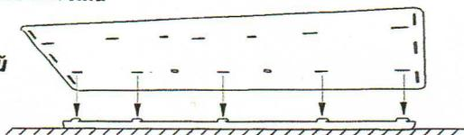
6. Сдвиньте ребро жесткости относительно лицевой панели (чтобы захваты вошли в зацепление):
