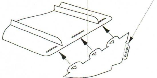
10. Возьмите фиксатор, поставьте его в прорезь боковой стенки и поверните до "щелчка", аналогично установите второй и третий фиксаторы.
