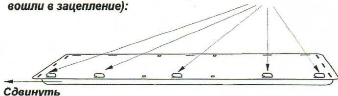
7. Если Вы сдвинули ребро жесткости правильно (до конца), то сработают стопоры (шпильки войдут в пазы):
