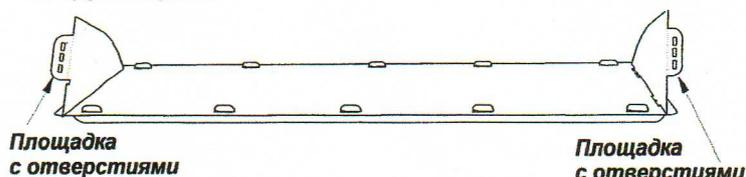
12. Навесьте экран на крючки. При этом крючок должен войти в ВЕРХНЕЕ ОТВЕРСТИЕ:
